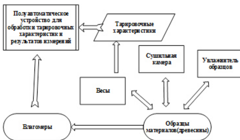
Рис. 1. Схема устройства для тарирования приборов косвенного измерения влажности материалов
