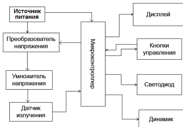
Структурная схема прибора измерения радиации
